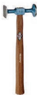
**Spezial Ausbeul- u. Schlichthammer****Shrinking Hammer****Karosseriebauer**
