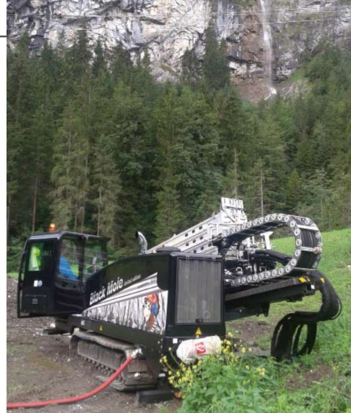
Image au dessus: Le système GRUNDODRILL 18ACS sur le chantier.
